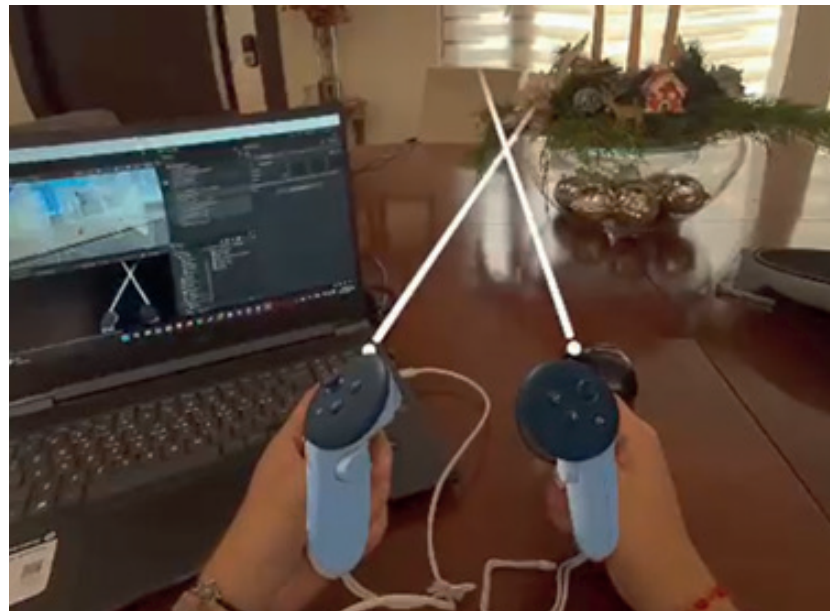
Fig.3 – Componente Ray interaction para interactuar con el rayo cursor.
